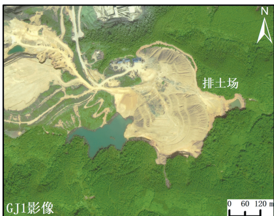
图 3 建筑用砂排土场遥感解译标志
