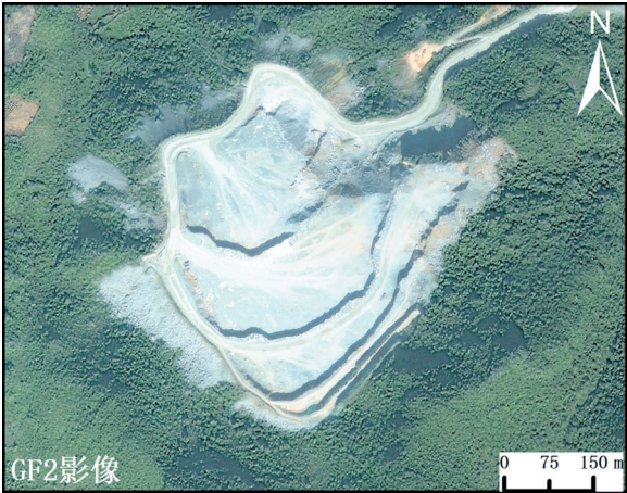
图 2 建筑用砂露天采场遥感解译标志
