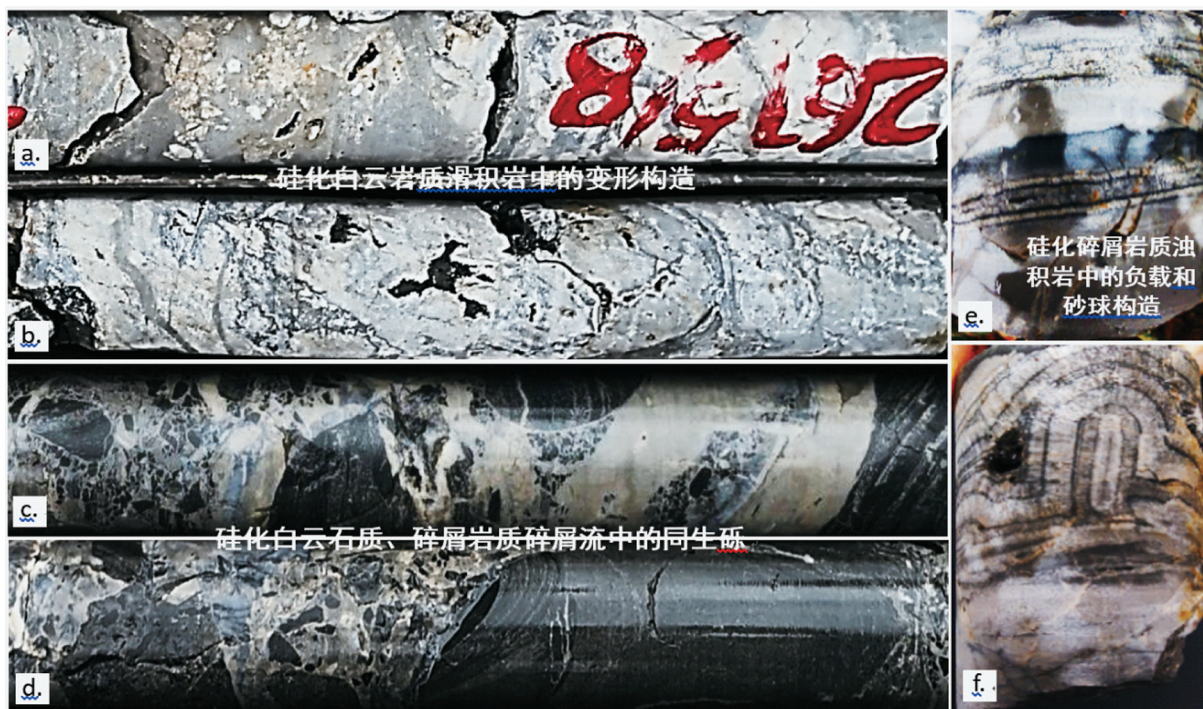
图5 大湾磷矿区a矿层和b矿层之间夹石层的水下重力流特征
